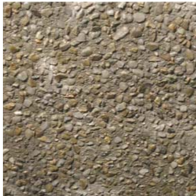
Abbildung 8: Waschbetonoberfläche mit heller Gesteinskörnung [Foto VÖZFI]
