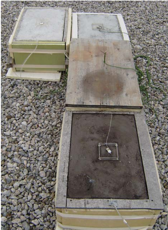
Abbildung 4: Versuchskörper zur Messung des Erwärmungsverhaltens am Dach des Institutsgebäudes der Vereinigung der österreichischen Zementindustrie [Foto VÖZFI]
