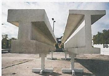
T-Träger aus herkömmlichem Stahlbeton und Carbonbeton
