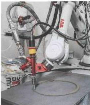
Mit dem BauMinator® bietet Baumit ein System für den 3D-Betondruck. © Baumit
