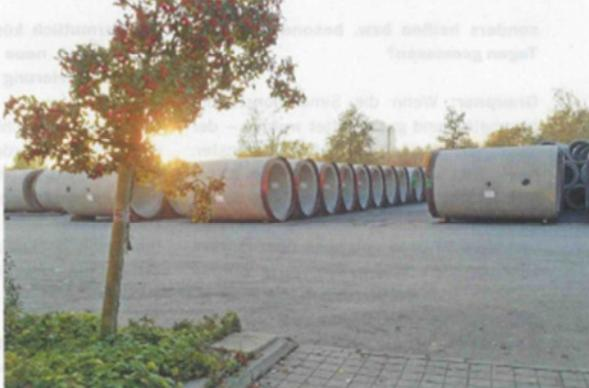
**HABA-Beton (Johann Bartlechner KG) produzierte Fertigteile für ca. 2.000 Laufmeter Vortriebsrohre mit 2,5 bzw. 3 Meter Außendurchmesser und 4 Meter Länge**
