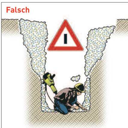
Gefahr: Künette nicht abgesichert
