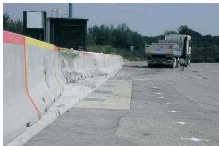
H2/TB51-Prüfung mit 16-t-Bus an Delta Bloc® 80AS-R und H4b/TB81-Prüfung mit 38-t-Sattelschlepper an Delta Bloc® 100AS-R
