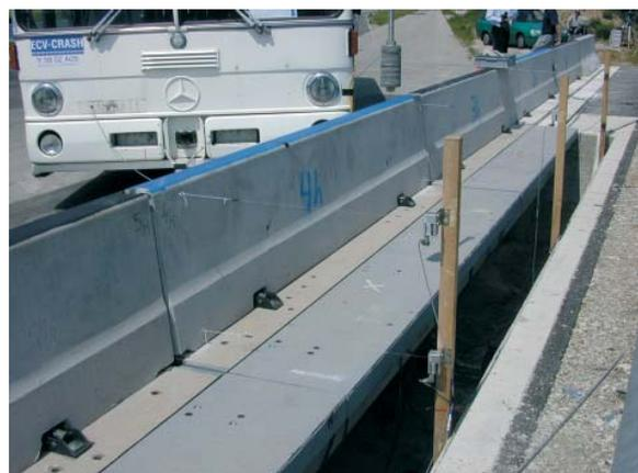
Im Herbst 1999 wurde am Prüfgelände des TÜV-Bayern in München/Allach eine weltweit einzigartige Versuchsanlage in Betrieb genommen. In einer Messgrube sind drei Konsolen aus Betonfertigteilen mit jeweils 4,0 m Länge angebracht. Jede Konsole lagert auf zwei Aufhängungen, die durch je drei Stäbe gebildet werden. Das Rückhaltesystem wird so aufgestellt, dass der Anprallbereich über der Messgrube zu liegen kommt. Gemessen werden können:
