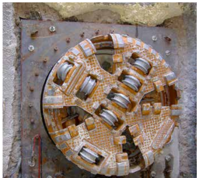
Schneidrad nach 900 lfm Vortrieb
