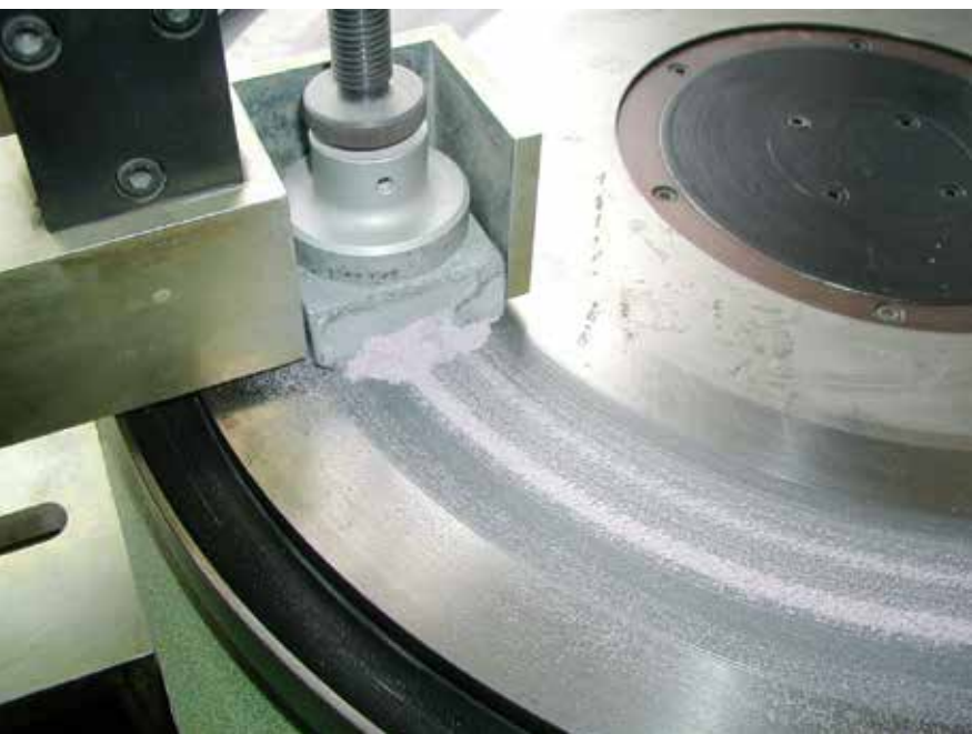
Bild 4: XM1 Prüfung mechanischer Abrieb nach Böhme
