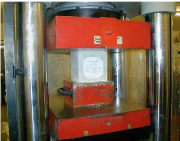
Bild 2: Druckfestigkeit von Beton
