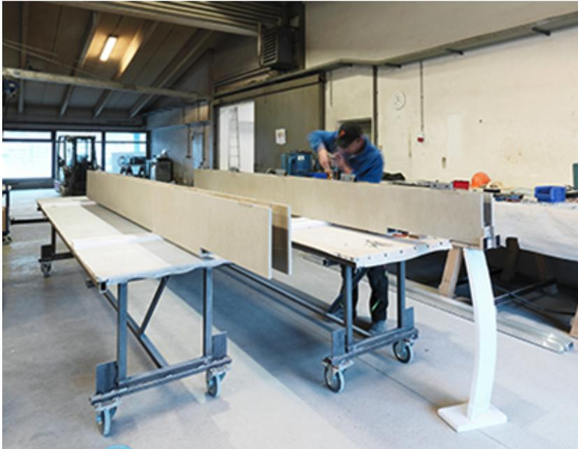
Zur nicht sichtbaren Befestigung wurde ein intelligentes System mit integrierten Befestigungsankern entwickelt. Die witterungsunabhängige Vormontage im Werk gewährleistet einen hohen Qualitätsstandard und eine rasche Montage bauseits. Die Elemente werden auf der Baustelle einfach eingehängt und feinjustiert. Durch ihr geringes Gewicht sowie ihren hohen Spannweiten ist weniger Material an Unterkonstruktion erforderlich.
