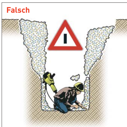
Gefahr: Künette nicht abgesichert
